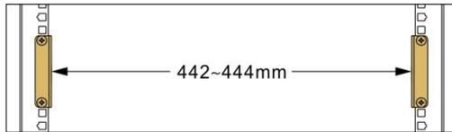
图 12 托板安装宽度
